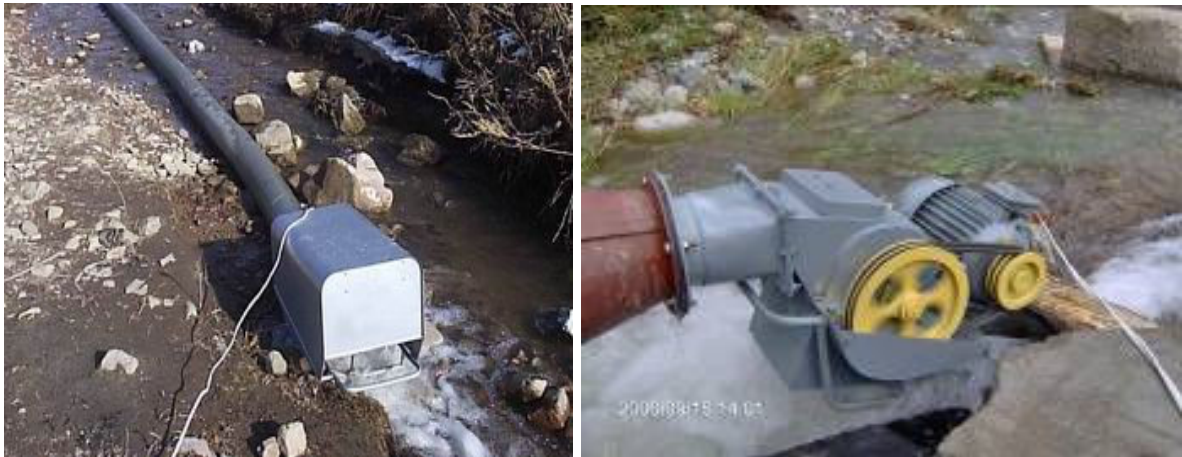
Рис. 3.3 Рукавная пико ГЭС с двукратной, поперечноструйной гидротурбиной типа Банки
