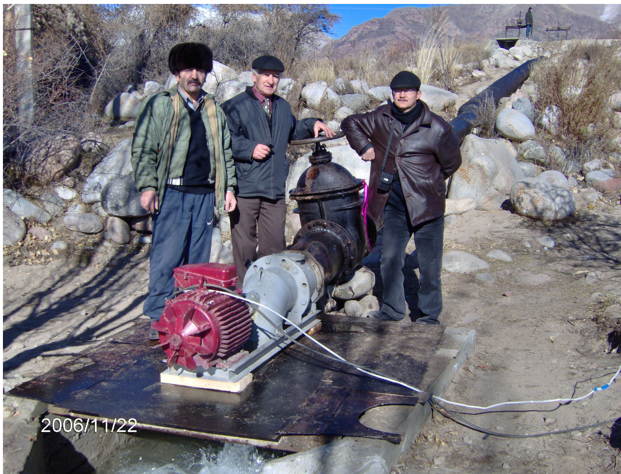
Рис. 6.8 Гидрогенератор мощностью 8 кВт с горизонтальной пропеллерной гидротурбиной около села Чон Сары Ой Иссык-Кульской области. Первый пуск.
